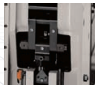
Régulation fine du point mort bas sur le coulisseau pour un point mort bas optimum ; incrément 0.1 mm.
