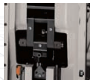
Réglage fin du point mort bas sur le coulisseau pour un point mort bas optimum ; incrément 0.1 mm.
