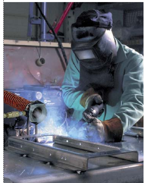
Évacuation de fumée de soudage par Transvector.
