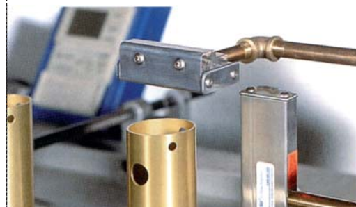
Les Transvecteurs à rideau d'air permettent de souffler ou de refroidir sur de grandes largeurs.
