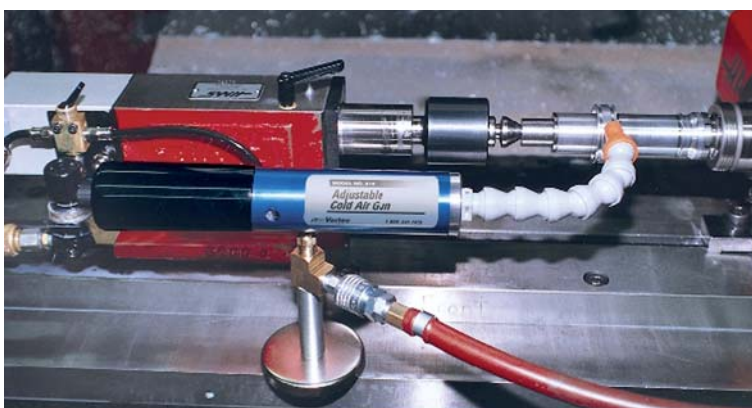
Pistolet d'air glacé 610 : application de refroidissement localisé.
