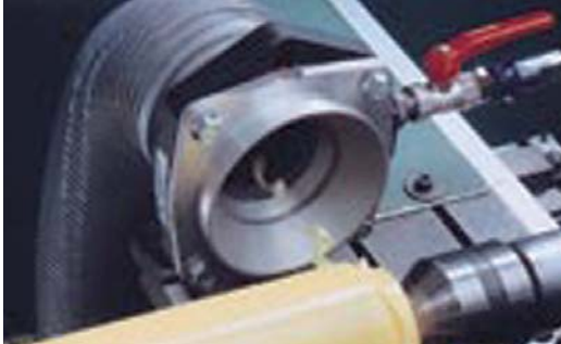
Les Transvectors permettent de capter copeaux et poussières à la source.
