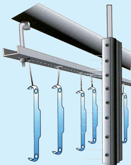
> Séchage de pare-chocs automobile sur un convoyeur avant peinture
