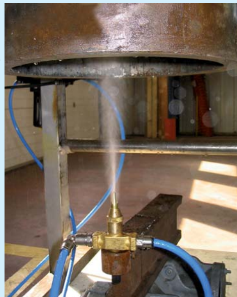
> Le sprayvector refroidit la pièce sans la mouiller
